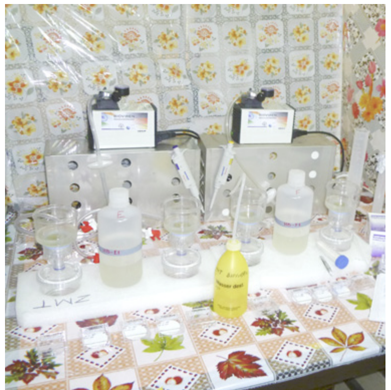
Chemisches Behelfslabor in Kolkata mit der Hauptaufgabe der Trennung des partikulären Materials zur separaten Analyse.
